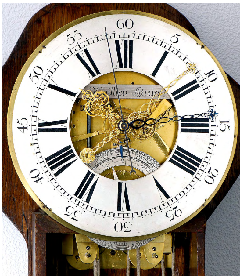
Abb. 128 + 129: (li.) Zifferblatt des Präzisionsregulators von Antoine Philippe Huillier mit dem breiten versilberten Ziffernring mit römischen Zahlen und außen dem Minutenring mit 5-er Sprüngen in arabischen Zahlen sowohl für die Anzeige der Mittleren wie auch der Wahren Zeit . Gut erkennbar durch den zentralen runden Ausschnitt die Technik zur Äquationsanzeige sowie die ausgefallenen 4 Zeiger: Die vergoldeten für die Stunden und die WZ-Minute, die aus gebläutem Stahl für die Zentralsekunde und die MZ-Minute (weitere Details s.u.). / (re.) Seitlicher Blick in das Werk mit Monatsgang und Graham-Hemmung.
