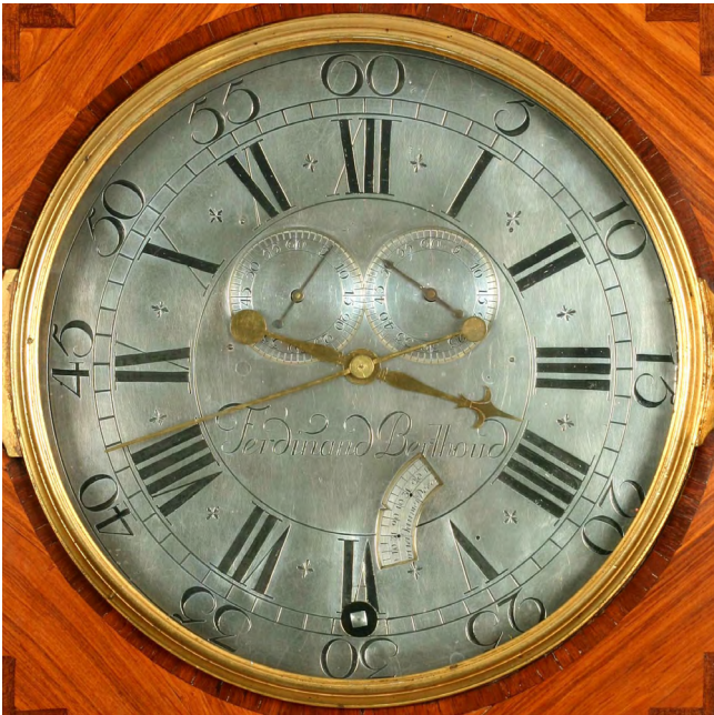
Abb. 108: Louis XVI.-Präzisionsregulator mit Jahresgang, Jahreskalender und Äquationsanzeige durch einen kleinen MZ-Minutenkreis im Zifferblatt oben rechts neben der kleinen Sekundenanzeige sowie einem WZ-Minutenzeiger aus der Mitte und einem Experimental-Kompensationspendel nach Ellicott mit Schneidenaufhängung von Ferdinand Berthoud à Paris , etwa 1760.
