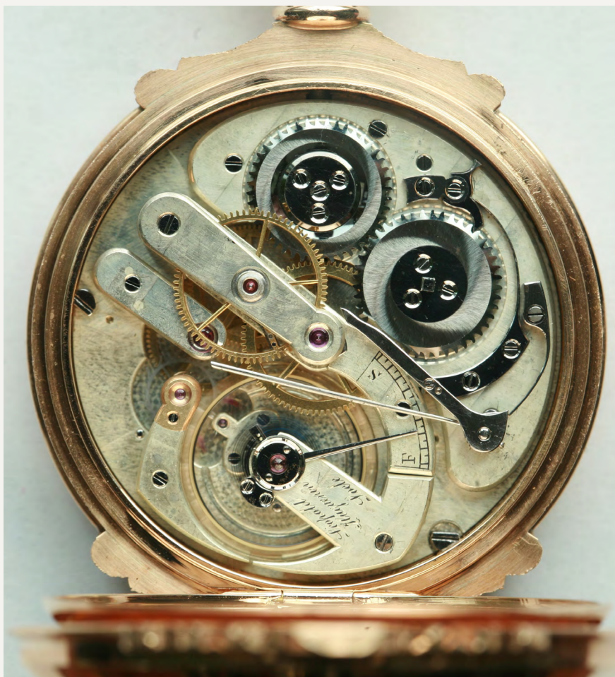
Abbildung 15. Der Chronographenmechanismus der Huguenin-Uhr. Man beachte die bemerkenswerte Einfachheit des Chronographenmechanismus.
