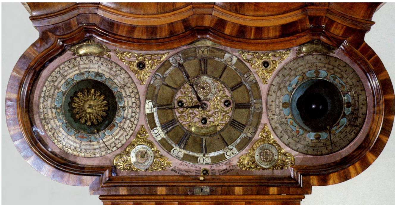
Abb. 090 + 091: Das Zifferblatt der Hüsgen-Uhr in Großaufnahme. S.a. ob. die entsprechende Zeichnung = Teil 1 Abb. 016. Links der Sonnenstand, in der Mitte die Mittlere bzw. Wahre Zeit und rechts die Mondstandanzeigen. Die Anzeigen des Datums darüber s. ob. bei der s/w-Abbildung. Der Kopf hat an dieser Stelle eine Breite von 97,2 cm. Noch zu einer netten Funktion unten in der Gehäusetür = die Gangreserve-Anzeige (l.u.). Hinter dem Glasfenster ist ein vergoldeter Mann, der einen versilberten (noch) stehenden Bären mit einer Kette an der Hand hält. Einen Tag bevor das 8-Tagewerk abläuft, liegt der Bär auf dem Rücken am Boden und richtet sich beim Werkaufzug wieder auf.
