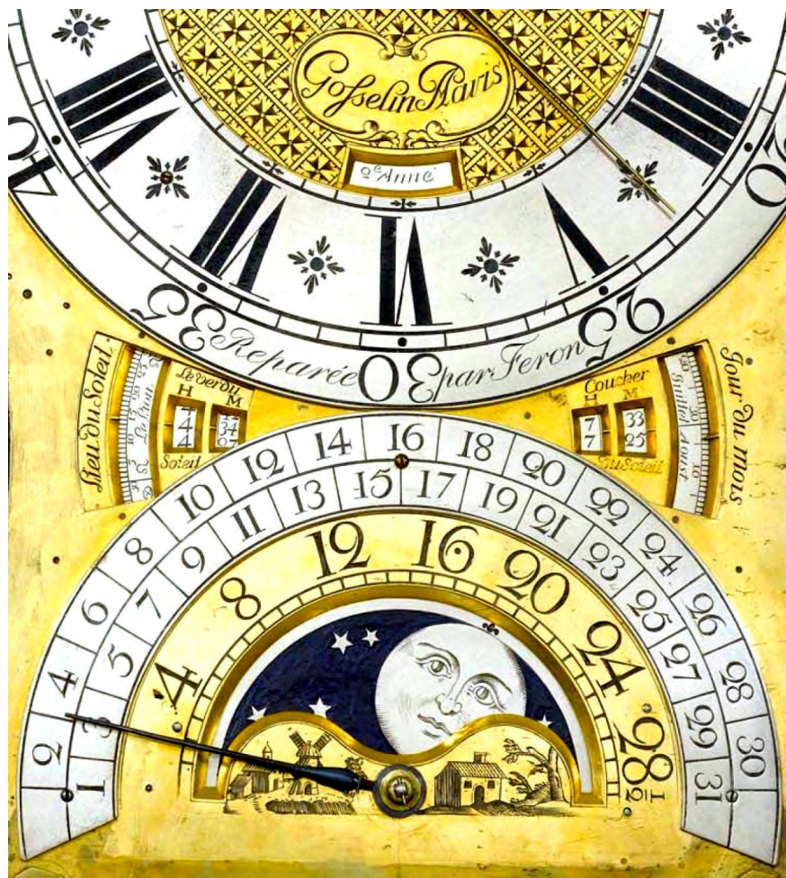
Abb. 078: Ausschnitt des vergoldeten großen Zifferblattes, oben mit dem versilberten Zifferring, dem vergoldeten WZ-Minutenzeiger, der Signatur „Gosselin Paris“ und dann im Hinblick auf den Ewigem Kalender, die Jahreszeitfolge im Schaltjahr-Rhythmus, hier das 2. Jahr (2 e Année). Darunter befinden sich die Sonnen-Auf- und -Untergangszeiten. Dann folgen im Halbkreis außen die Tage von 1 bis 31 und darunter die Mondphasenanzeige mit den Tagen bis 29 ½. / Den Kopf der Uhr siehe oben in Großabbildung (Teil 1 Abb. 026) ebenso wie das obere Uhrenteil ohne die Kopfhäube (Teil 1 Abb. 025).
