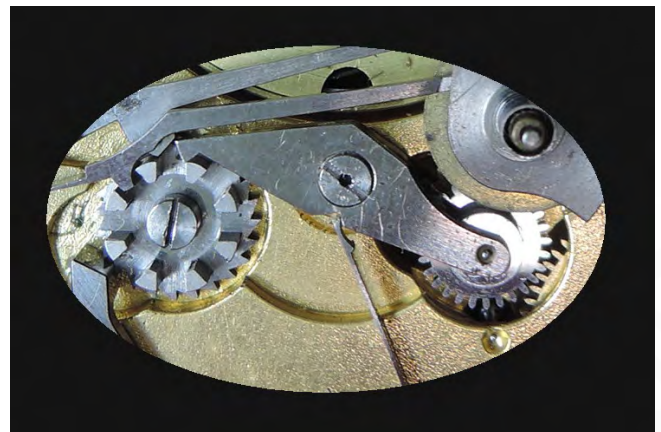
Abbildung 17. Die horizontale Kupplung von Nicole und das zugehörige steuernde Schlossrad. Von einem Nicole-Nielsen-Chronographen, ca. 1900.
