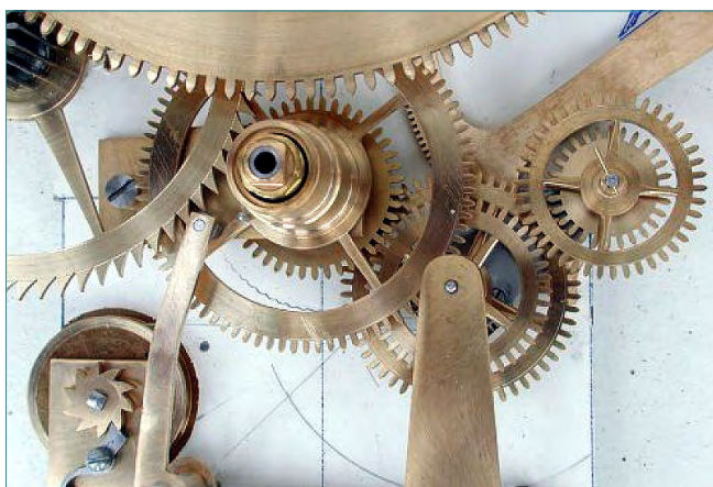
Abb. 099: Komplettes Räderwerk des Kalender-, Zeiger- und Differentialgetriebes; oben sichtbar hinter der noch nicht gravierten Kalenderscheibe / Rad, die Nierenscheibe für die Zeitdifferenzen; links das von Kinzing genial gelöste Kalenderwerk mit nur zwei Rädern und einem Trieb.
