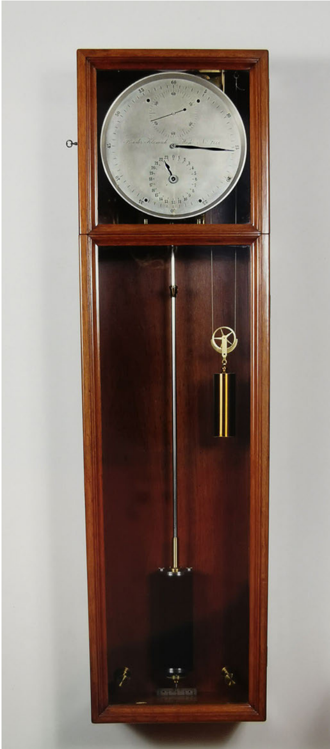
26 Präzisionspendeluhr mit Regulatorzifferblatt, Wochenwerk, Stahl (Invar?)-Pendel mit Quecksilber gefülltem Eisenzylinder; Quelle: Privatbesitz
