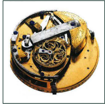
Verschiedene Konstruktionen früher Pedometeraufzüge
