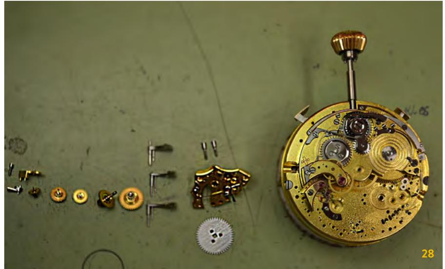
Diese Uhr besitzt mehr als 400 Teile. Besondere technische Unterschiede werden ausdrücklich herausgestellt. Z.B. findet der Chronographen-Mechanismus keinen Vergleich in der Literatur. Beim Kalender schaltet um 24 h der Mechanismus nicht, wie meist üblich, schleichend, sondern schlagartig auf den nächsten Tag um.
