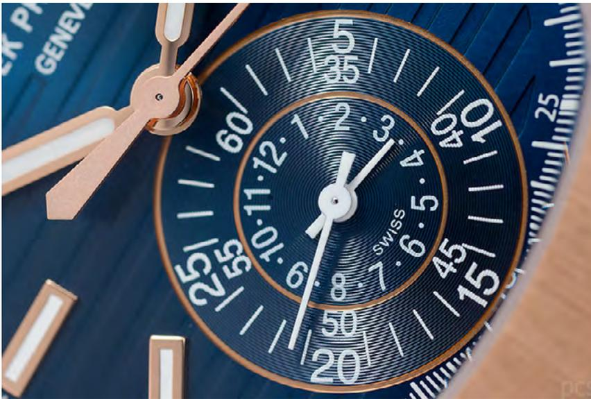
**A**m äußeren Skalenring werden die gestoppten Stunden abgelesen, im Inneren die Minuten. Interessant, dass Patek Philippe somit, verglichen mit der 5980, eine genau gegensätzliche Anordnung bevorzugt.
