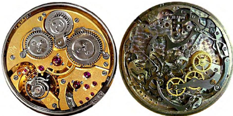
7 César Racine, 20" Minuten-Repetition mit großem Lütwerk (linkes Bild mit spezieller Feinregulierung von Charles Rosat, CH-Patent Nr. 24025 von 1902 sowie dem Fliehkraftregulatorssystem von Dietisheim & Cie., CH-Patent Nr. 15833 von 1898)
