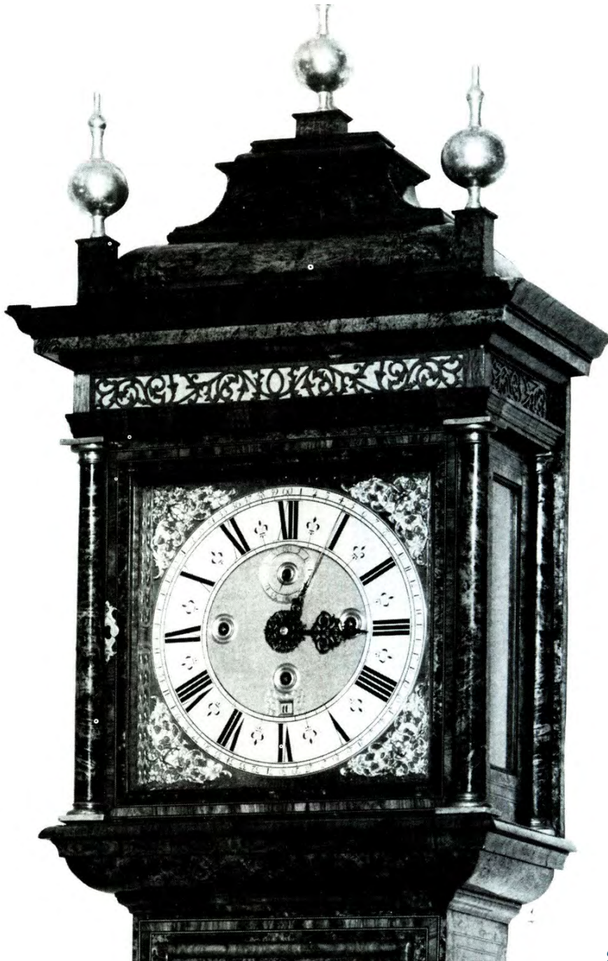
Abb. 0009 + 0010: Hier ist links der Kopf der 8-Tageuhr mit Grande Sonnerie von Christopher Gould, ~1695–1700 , zu sehen. Das schmuckvolle Zifferblatt ist größer und hat oben einen Strike (Schlagen)/Silent (Nicht Schlagen)-Mechanismus zum Abstellen des Schlagwerkes. Rechts ist das Werk (mit Ankerhemmung) von oben und die 6 Glocken für das Schlagwerk zu sehen. Eine hochqualitative Uhr von Gould. Fotos: Dawson... 1656
