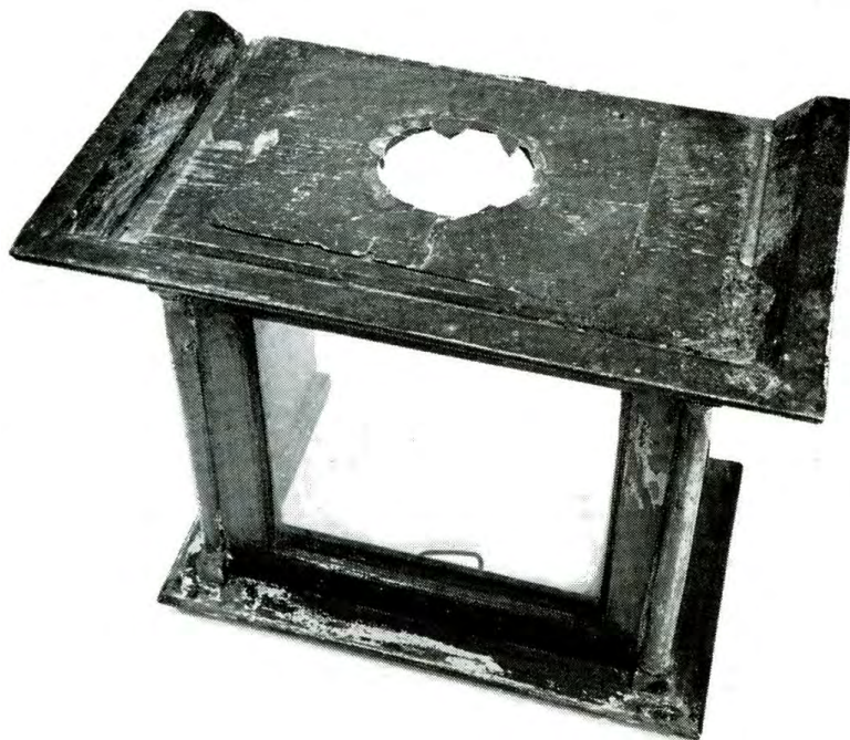
Abb. 0013: Eine typische frühe Schallöffnung in der Haube eines Standuhrenkopfes um 1680 (hier von Wm. Lasseter, Arundel). Die Öffnung wurde aber mit starkem Papier anstelle des früher verwendeten „hessian“ (Sackleinen) abgedeckt, das zerbrach und nicht mehr vor Staub schützte. Foto: Robinson 1653
