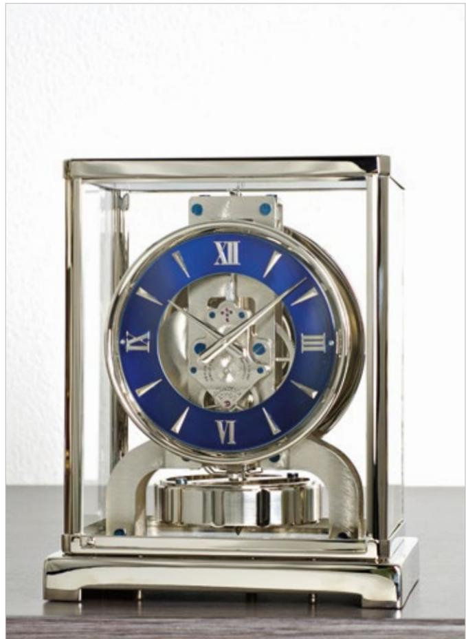
Die **Atmos** (Atmosphärische Uhr) gewinnt ihre Antriebsenergie aus den temperatur- und luftdruckabhängigen Volumenänderungen des Gases Chlorethan, das sich in der Druckdose befindet. Die dabei gewonnene Energie wird in einer mechanischen Feder gespeichert. Nach Herstellerangaben genügt ein Temperaturunterschied von 1 Kelvin, um die Uhr für etwa 48 Stunden aufzuziehen.
