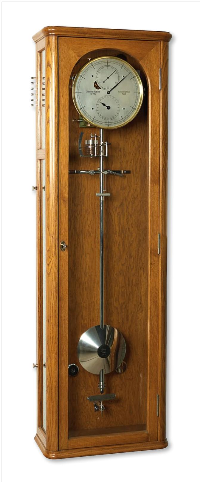
Diese Präzisionspendeluhr aus der Riefler'schen Manufaktur in Nesselwang ist vom Typ A<sup>3</sup>, der seit 1913 bis zum Ende der Produktion im Jahr 1965 mit nur wenigen konstruktiven Änderungen gebaut wurde. Laut dem Auslieferungsbuch ohne Pendel geliefert, wurde sie aber doch mit einem originalen Rieflerpendel vom Typ "J" versehen und ist im Übrigen mit der mechanischen Einstellvorrichtung durch kleine Zulagegewichte und die Druckkompensation mittels Aneroid bestens ausgestattet.
